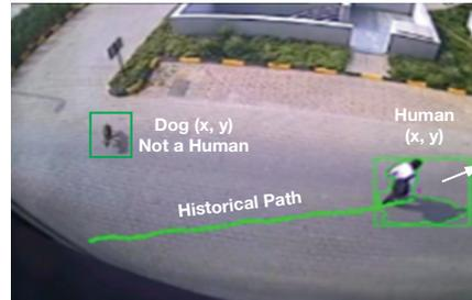
图8. 利用边缘节点视频分析，可在低功耗系统中确定对象类型检测、轨迹和边界交叉，而无需将全带宽视频数据发送至云端进行分析。只需传输时间戳及痕迹对象坐标和类型。
