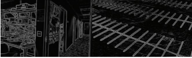
图9. 通过在边缘节点处部署采用DSP对象检测算法的高动态范围成像传感器, 即使在低照明条件下, 也可以确定运动和边界入侵。这个示例使用视觉对比来定义室内工厂/办公室(左侧)和室外停车场(右侧)的边缘检测。
